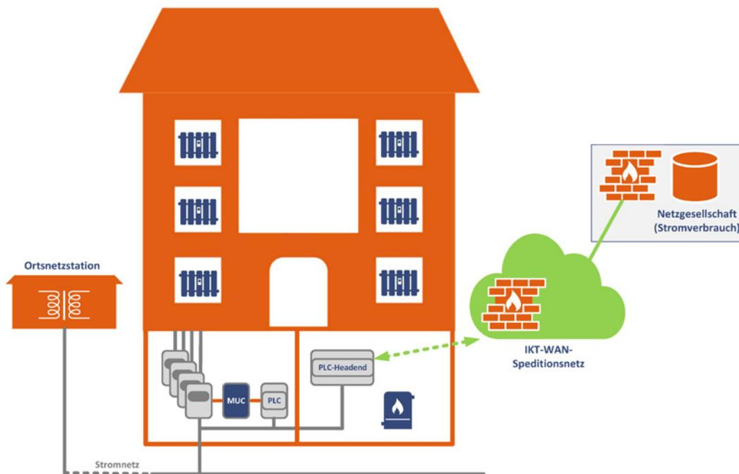
Abb. 35: Kommunikationskonzept Pilotobjekte Sausenberger Straße 26-34; 1. Evaluationsstufe mit MUC und Standard PLC-Kommunikation, © green with IT e.V.
