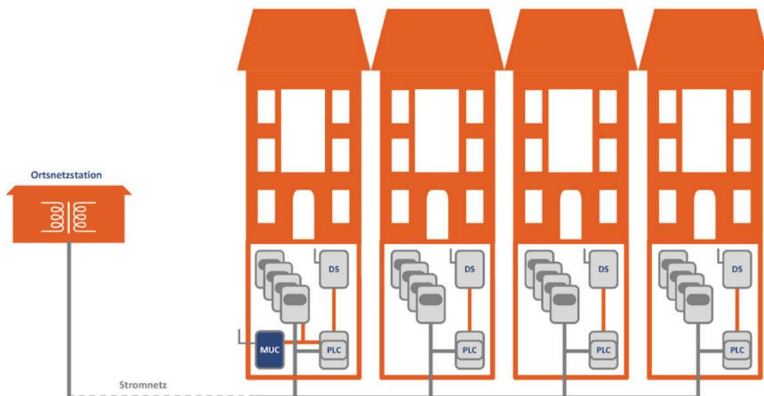
Abb. 28: Installationsort PLC Headend und WAN Schnittstelle, © green with IT e.V.
