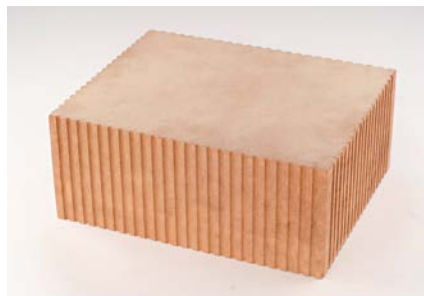
Der neue Ziegel besteht aus recyceltem Ziegelsand und trocknet an der Luft
