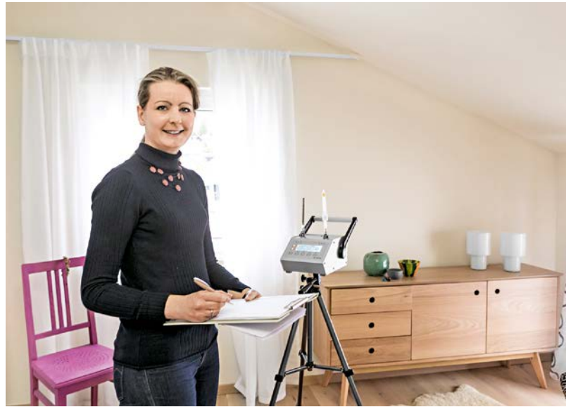
Raumluftmessungen sind wie eine Hauptuntersuchung für geprüft gesündere Gebäude. Bauherren können so überprüfen, ob bei Planung und Ausführung sorgfältig mit emissionsarmen Baustoffen gearbeitet wurde
